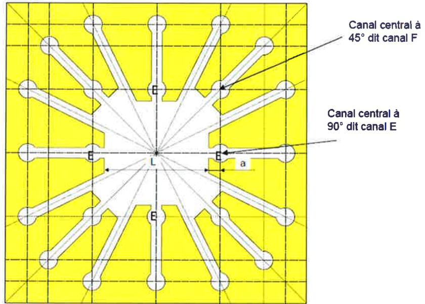
Schéma 1 : Section d'une carte de guidage d'un guide de grappe d'une tranche 1300 MWe
